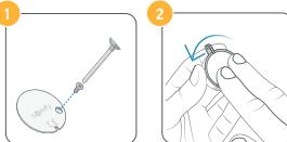
Entfernen Sie die Schraube, anschließend die Abdeckung der Fernbedienung und wechseln Sie die Batterie aus (1x 3 V Lithium-Panasonic oder Energizer CR2032).
