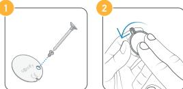
Verwijder de schroeven en vervolgens de behuizing van de badge en vervang de batterij (1 lithiumbatterij van 3 V Panasonic of Energizer CR2032).
