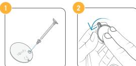
Retire o parafuso e, em seguida, a tampa do cartão e substitua a pilha (1x 3 V de ítrio Panasonic ou Energizer CR2032).
