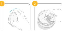
Open het paneel en vervang de batterijen (2 AA-alkalinebatterijen van 1,5 V).
