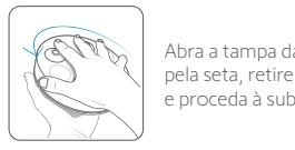
Abra a tampa da sirene no sentido indicado pela seta, retire a capa protetora das pilhas e proceda à substituição (4x 1,5 V alcalinas D).
