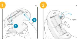
Zdejmij tylną pokrywę i wymień baterię (4 baterie alkaliczne 1,5 V D).
