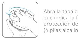
Abra la tapa de la sirena en el sentido que indica la flecha, retire la cubierta de protección de las pilas y sustitúyalas (4 pilas alcalinas D de 1,5 V).
