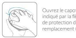
Ouvrez le capot de la sirène dans le sens indiqué par la flèche, retirez l'enveloppe de protection des piles et procédez au remplacement (4 x 1,5 V alcalines D).
