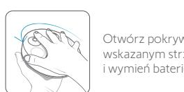
Otwórz pokrywę syreny w kierunku wskazanym strzałką, zdejmij osłonę baterii i wymień baterię (4 baterie alkaliczne 1,5 V D).
