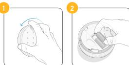
Ouvrez le clavier et remplacez les piles (2x 1,5 V alcalines AA).
