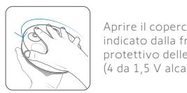
Aprire il coperchio della sirena nel senso indicato dalla freccia, rimuovere l'involucro protettivo delle batterie e sostituirle (4 da 1,5 V alcaline D).
