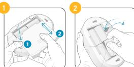
Verwijder het deksel aan de achterkant en vervang de batterijen (4 alkalinebatterijen van 1,5 V type D).
