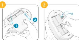
Retire a tampa posterior e substitua as pilhas (4x 1,5 V alcalinas D).
