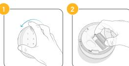
Abra el teclado y sustituya las pilas (2 pilas alcalinas AA de 1,5 V).
