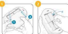
Retirez le capot arrière et remplacez les piles (4x 1,5 V alcalines D).
