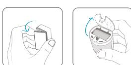
Otwórz pokrywę i wymień baterię (IntelliTAG®: 1 bateria alkaliczna 1,5 V AAA / Wewnętrzny czujnik ruchu: 1 bateria litowa CR123A 3 V).
