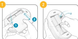
Rimuovere il coperchio del vano batterie facendolo scorrere all'indietro e sostituire le pile (4 da 1,5 V alcaline D).
