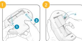
Abra el compartimento trasero y sustituya las pilas (4 pilas alcalinas D de 1,5 V).
